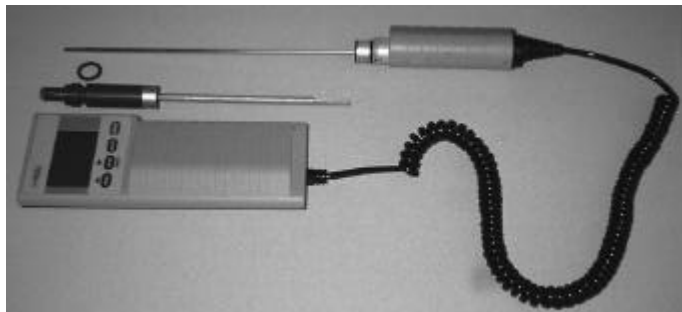
Abbildung 5.1.1 HMI41, HMP42 und Kalibrierzubehör
