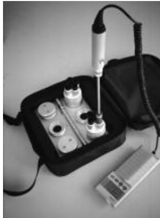
Abbildung 5.2.2 Die HMP42 in einem Salzgefäß des Kalibrators HMK15
